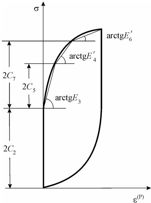
Рис. 2. Диаграмма циклического деформирования
