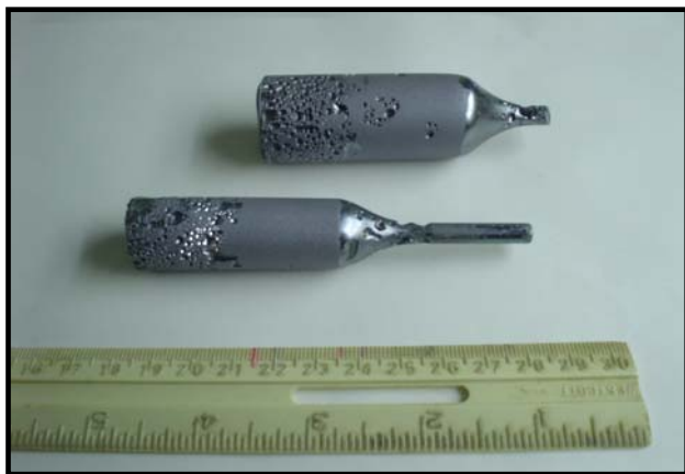
Рис. 3. Монокристаллы \text{ZnGeP}_2 , выращенные из расплава на затравки с кристаллографической ориентацией \langle 001 \rangle . Двойники и трещины отсутствуют.
