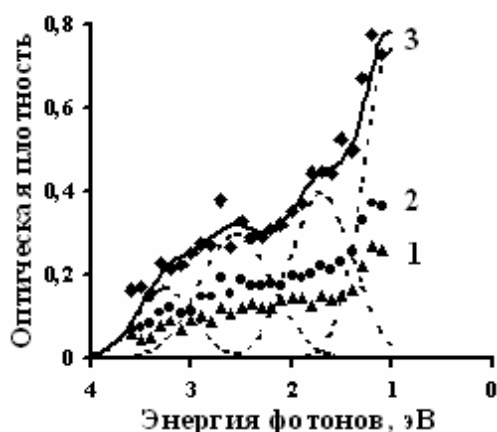
Рис. 3. Спектры оптического поглощения кристалла MLN-10.0, измеренные с различной задержкой относительно импульса облучения: 1 – t=0 мкс, 2 - t=0.5 мкс; 3 – t=0.1 мкс
