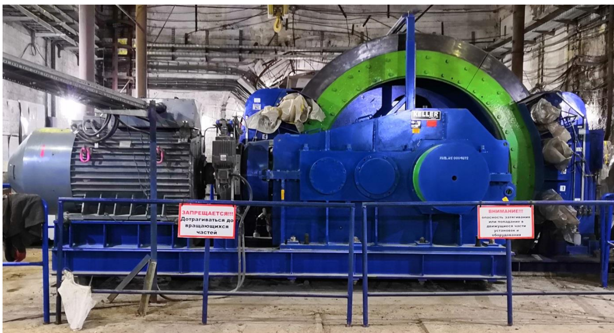
Рис. 1. Внешний вид скиповой подъемной машины подземного рудника
