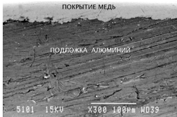
Рис.16. Микрофотография шлифа вертикального среза алюминиевого образца с медным покрытием.
