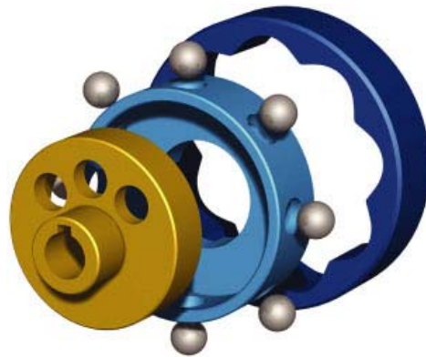
Рис.2. Устройство волнового редуктора с промежуточными телами качения
