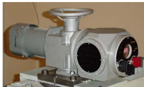
Рис.4. Электропривод запорной арматуры «ЭПЦ-100» с встроенным тиристорным регулятором напряжения «БУР»
