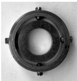
Рисунок 10 – Образец LiTiZn ферритовой керамики зажатый винтами М3 внутри стального тороида
