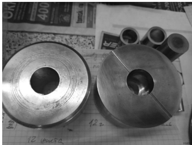
Рисунок 2.1 – Пресс-форма для изготовления образцов тороидальной формы
