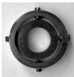
Рисунок 4.11 – Образец LiTiZn ферритовой керамики зажатый винтами М3 внутри стального тороида
