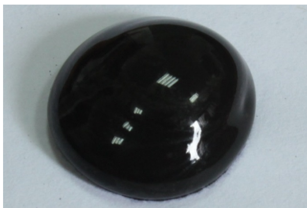
Рисунок 2.1. Внешний вид порции топлива, приготовленной из фильтр-кека каменного угля марки «Г»
