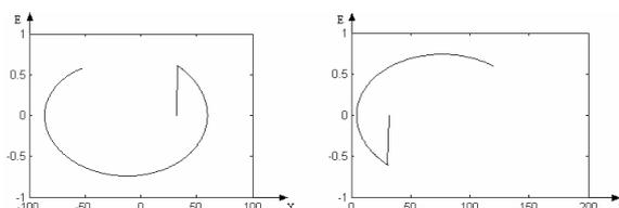
Рис. 3. Фазовые траектории для конвертера с повышением напряжения
