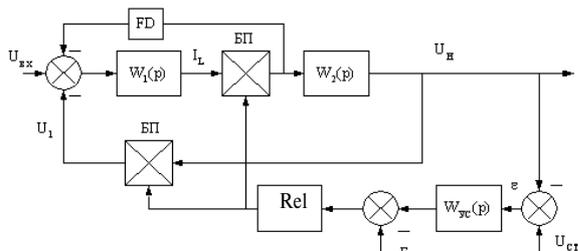
Рис. 2. Детализированная структурная схема преобразователя с повышением напряжения
