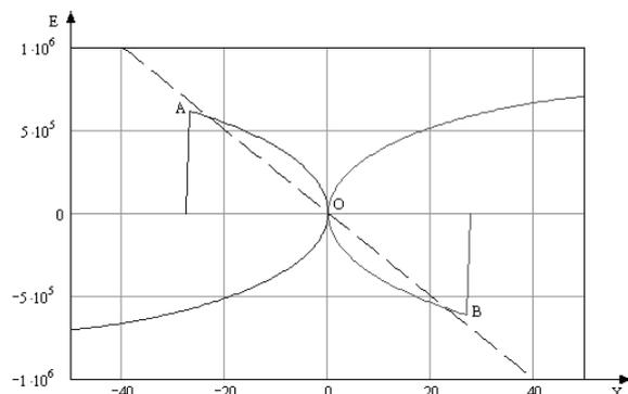
Рис. 4. Фазовые траектории и линия переключения в *Mathcad*
