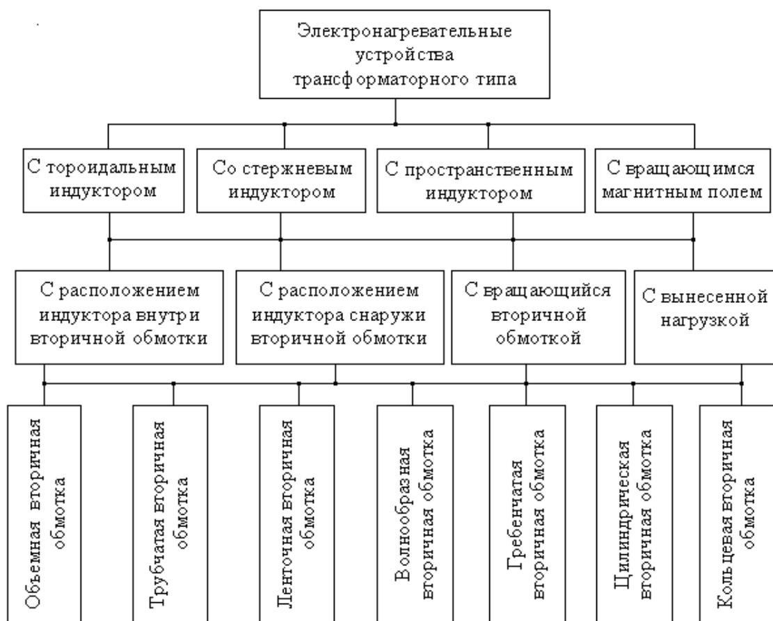
Рис. 1. Классификация электронагревательных устройств трансформаторного типа.
