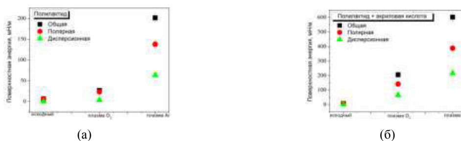
Рис. 2. Поверхностная энергия образцов ПЛ до и после обработки плазмой кислорода и аргона (а) и с прививкой акриловой кислоты на предварительно обработанную плазмой поверхность ПЛ (б)
