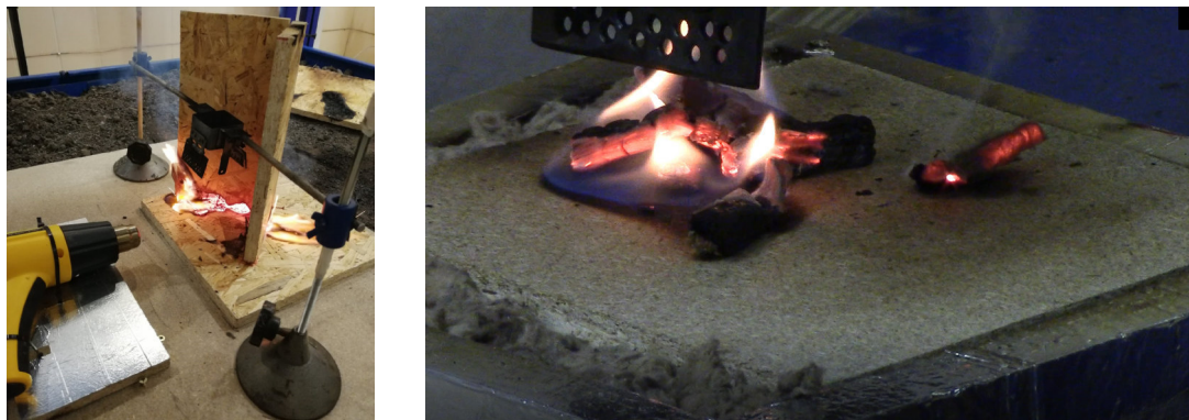
Рис. 2. Фотография развития процесса горения строительной конструкции в результате аккумуляции частиц
