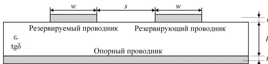
Рис. 2. Поперечное сечение МПЛ с однократным МР
