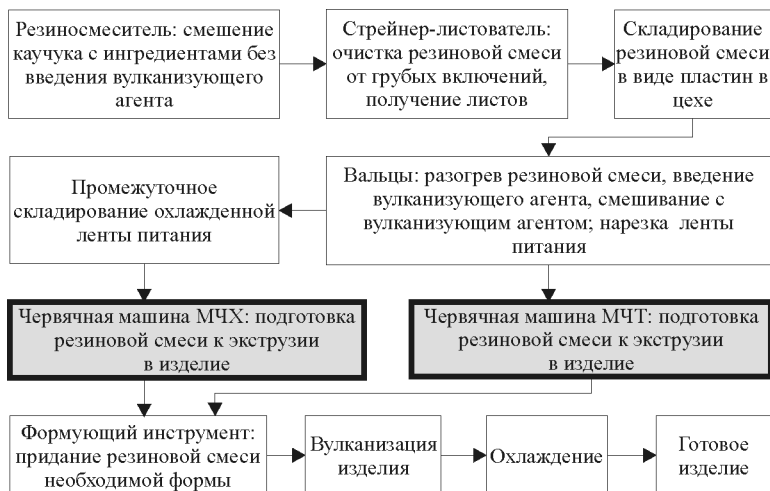
Рис. 1. Технологическая схема изготовления РТИ
