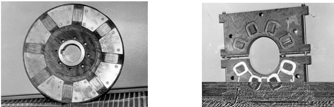
Рис.10. Фрагмент активной зоны модуля ротора и статора
