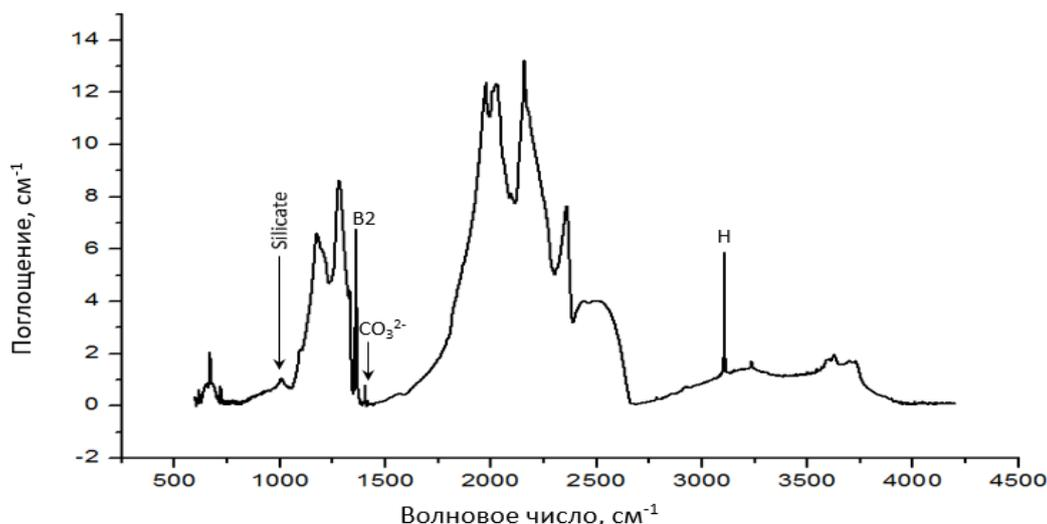
**Рисунок. Представительный ИК-спектр кристалла алмаза переходной формы из месторождения Снейп Лейк. Спектр отображает азотные дефекты и поглощения, обусловленные присутствием карбонатов и силикатов**
