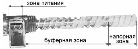
Рис. 2. Распределение модельной среды вдоль оси двухзаходного червяка
