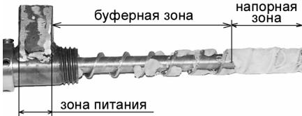
Рис. 1. Распределение модельной среды вдоль оси однозаходного червяка
