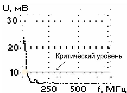
а) спектр ЧР на дефектной гирлянде фарфоровых изоляторов.
