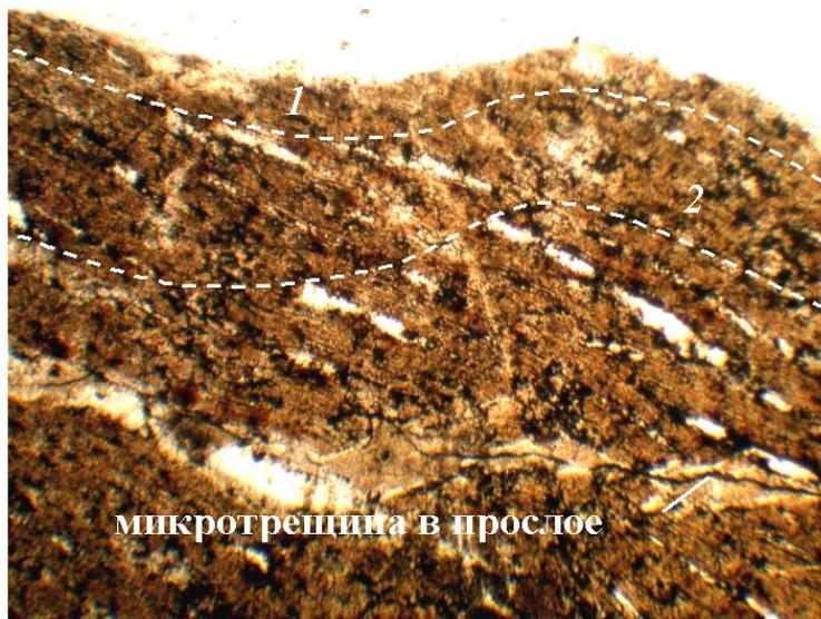
Рис. 5. Зона предразрушения в образце анизотропной породы: 1 – область разрушенной породы (до 0,12 мм); 2 – область пластических деформаций (до 0,42 мм). Увеличение в 57 раз.
