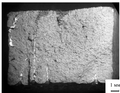
Рис. 9. Ситовидные раковины в изломе вертикальной центробежной отливке из
