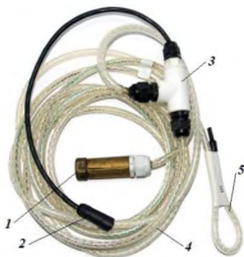
Рисунок 7 – Датчик уровня воды: 1 – датчик; 2 – разъем; 3 – воздушный тройник; 4 – полый соединительный кабель; 5 – трубка
