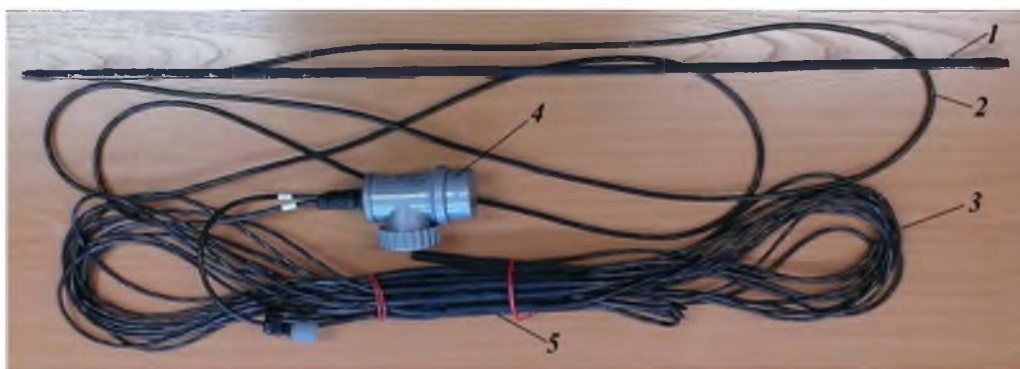
Рисунок 6 – Многоподатчиковые температурные зонды: 1 – температурный зонд; 2 – соединительный кабель между зондом и контроллером; 3 – соединительные кабели между сегментами термокосы; 4 – контроллер-регистратор; 5 – сложенные сегменты термокосы
