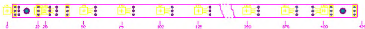
Рисунок 1 – Конструкция печатной платы измерительной линейки с размещенными на ней датчиками температуры DS18B20 при пространственном разрешении 25 мм
