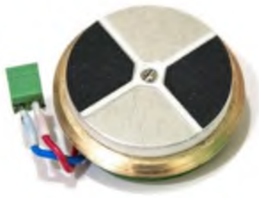
Рисунок 8 Блок контроля потока солнечной радиации: а) внешний вид измерительного модуля; б) функциональная схема БИСР
