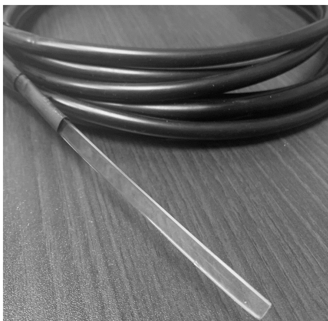
Рисунок 3.3.2 – Внешний вид детектирующего сцинтилляционного элемента
