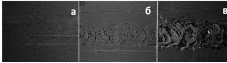
Рисунок 5.6 – СЭМ изображения поверхности плёнки ( $U_{cm} = 0$  В)  $TiO_2$  после царапания: на начальной стадии нагружения (а), в середине (б), в конце (в)
