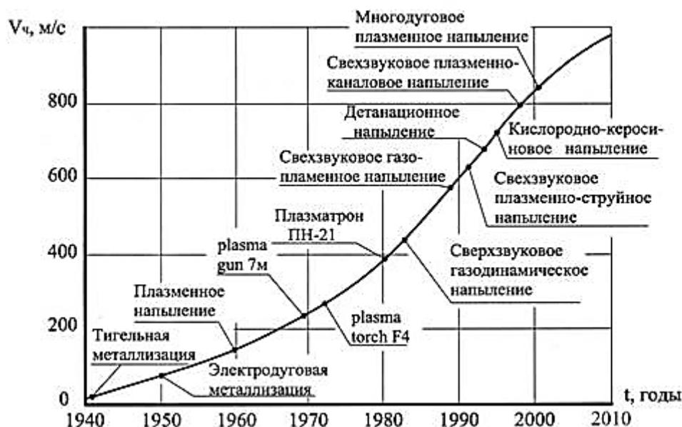
Рисунок 1.3 – Диаграмма модернизации способов напыления [15]
