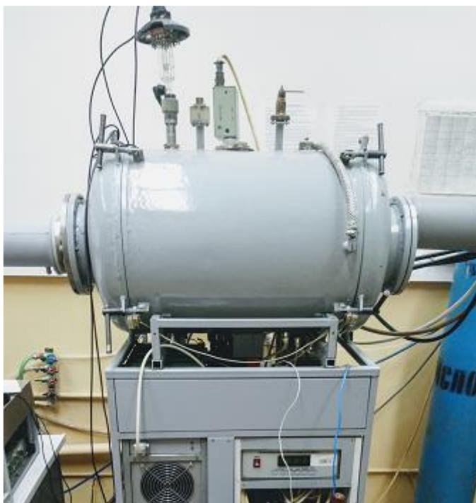
Рисунок 2.2 – Фотография реактивной распылительной установки «УВН-200МИ»
