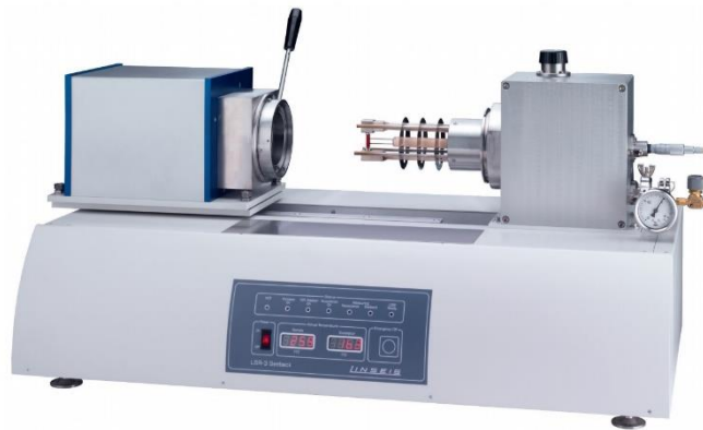
Рисунок 1.20 – SR-3 Linseis – анализатор коэффициента Зеебека и электрического сопротивления
