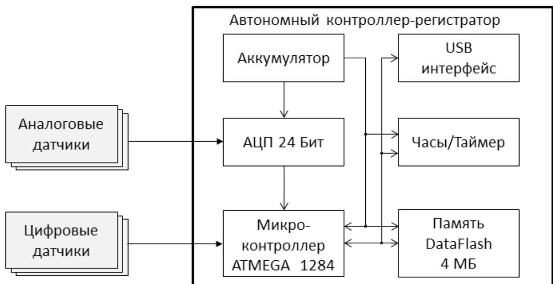
Рисунок 4.8 – Функциональная схема типового Регистратора
