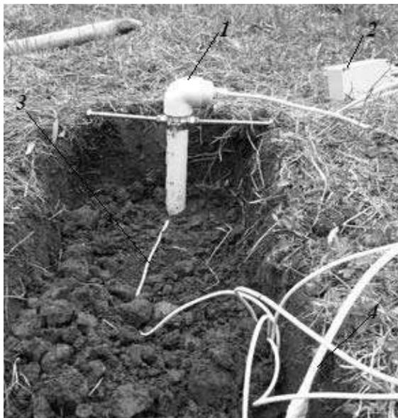
Рисунок 2.12 – Сравнительные измерения температуры почвы зондом из пластиковой трубы и одиночными датчиками: 1 – термозонд в пластиковой оболочке; 2 – контроллер-регистратор; 3 – соединительный кабель, идущий от одиночного зонда; 4 – соединительные кабели
