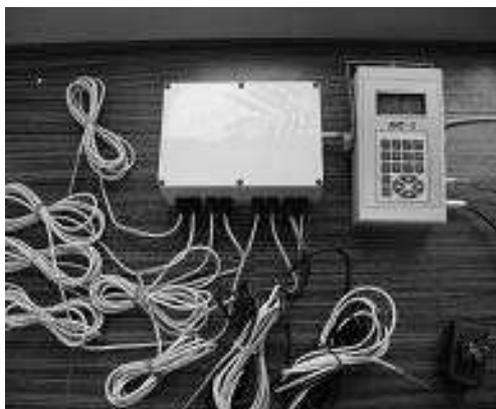
Рисунок 1.11 – Термометр почвенный АМТ-5 [25].
