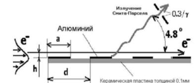
Рис.14. Геометрия установки мишени,  $h$  – импакт-параметр;  $0.3/\gamma$  – ширина оптического коллиматора;  $\gamma$  – Лоренц-фактор;  $d=100$  мкм,  $a=50$  мкм.
