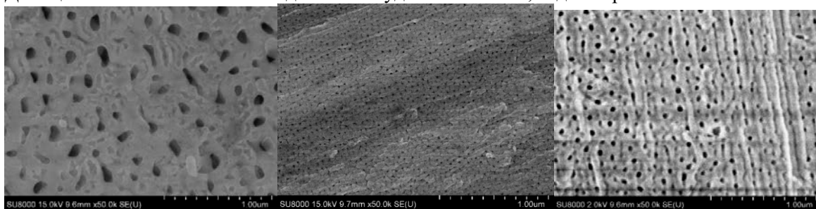
Рисунок 3 – Снимки СЭМ поверхностей образцов алюминия, полученных при анодировании в электролитах 0,3 \text{ M H}_3\text{PO}_4 (слева), 0,3 \text{ M C}_2\text{H}_2\text{O}_4 (по центру) и 0,2 \text{ M H}_2\text{SO}_4 (справа)
