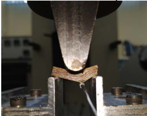
Рисунок 1 – Фото образца в захватах испытательной системы с датчиком АЭ
