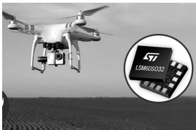
Рисунок 1.6 – Датчик движения LSM6DSO32 , примененный в беспилотном летательном аппарате
