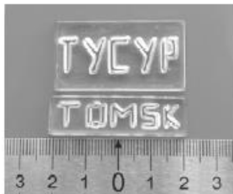
Рисунок 1.3 – Результат фрезеровки кварцевой пластины электронным лучом
