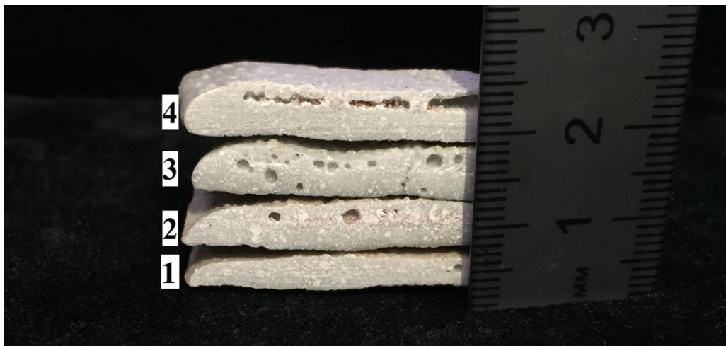
Рисунок 5.6 – Фотографии поперечных сечений образцов керамики MgF_2 , синтезированных в поле потоков с мощностью: 1 – 13 kBt/cm^2 , 2 – 15 kBt/cm^2 , 3 – 17 kBt/cm^2 , 4 – 19 kBt/cm^2
