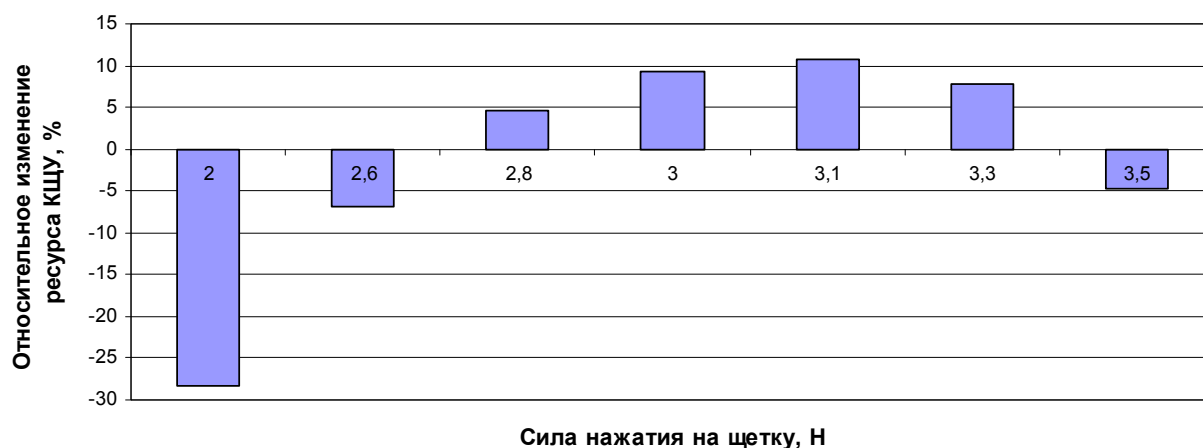
Рис. 9. Изменение ресурса КЩУ электродвигателя LG VCE280E02 в зависимости от величины нажатия на щетку с учетом изменения механического состояния КЩУ
