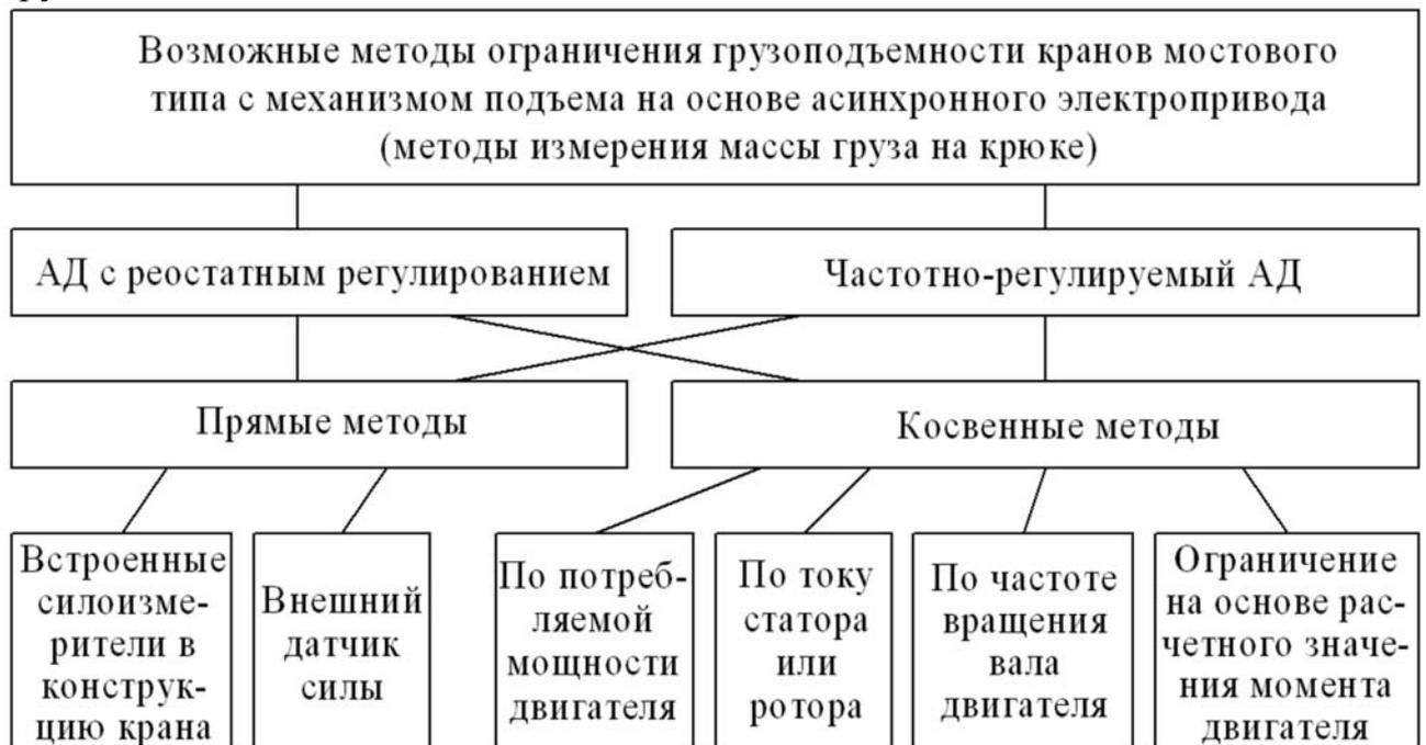
Рис. 1. Способы ограничения грузоподъемности АЭП механизма подъема мостового крана
