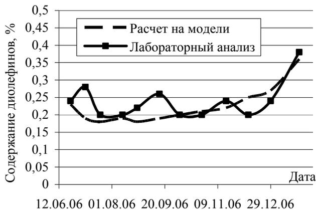
Рисунок 2 — Сравнение рассчитанных и экспериментальных содержаний диолефинов в выходном потоке реактора гидрирования (июнь–декабрь 2006 г.)
