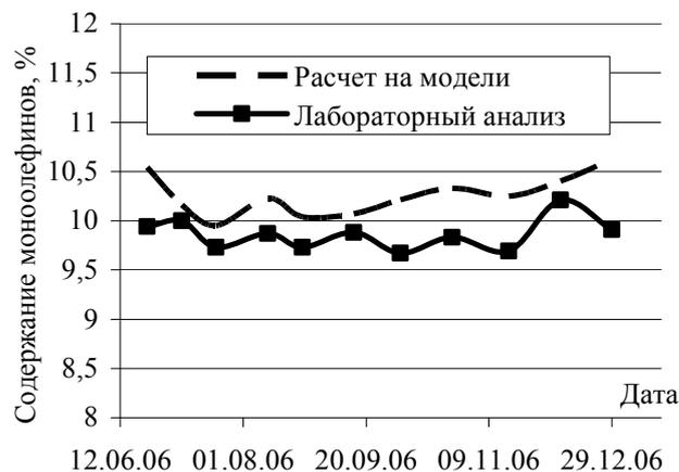
Рисунок 3 — Сравнение рассчитанных и экспериментальных содержаний моноолефинов в выходном потоке реактора гидрирования (июнь–декабрь 2006 г.)
