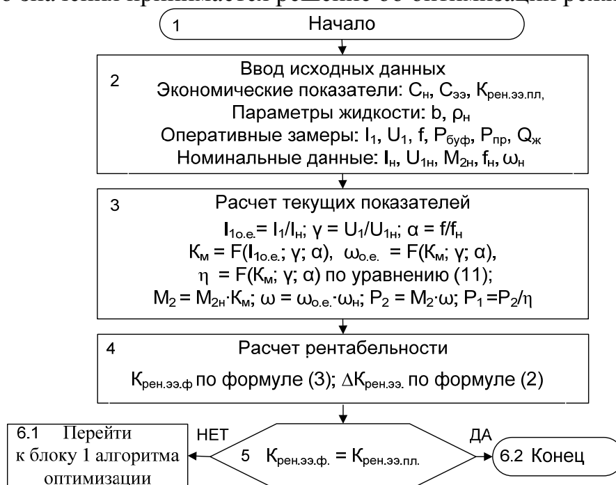
Рисунок 6 – Блок-схема алгоритма расчета текущего состояния системы
