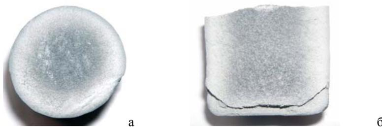
Рисунок 3 – Поперечный (а) и продольный (б) разрез образца, сгоревшего в поверхностном режиме
