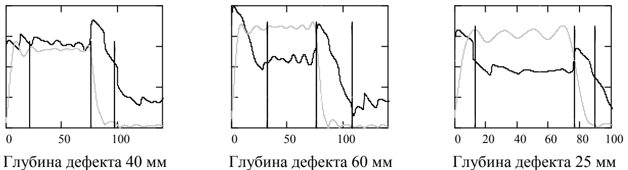
Рисунок 7 – Фазовые характеристики разностных сигналов. Серым обозначены огибающие радиоимпульсов сигналов откликов, черным – мгновенная фаза разностного сигнала. По вертикальной оси – относительные единицы, по горизонтальной – время в мкс
