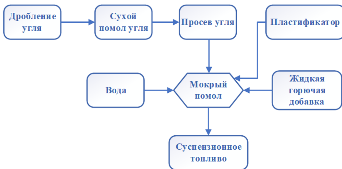
Рисунок 2.1 – Схема подготовки топлива
