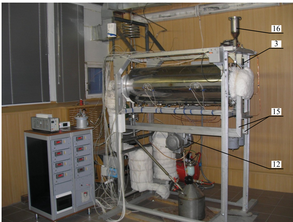
Рисунок 5.2 – Внешний вид блока пилотного реактора в составе установки совместного производства УНВ и водорода из природного газа: (подробно обозначения см. на рисунке 5.1, здесь 3 – пружина растяжения; 12 – дебалансный вибратор; 15 – П-образные элементы рамы реактора; 16 – дозатор катализатора)
