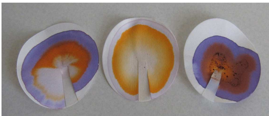
Рис. 2. Хроматография: разделение лакмуса синего и металла оранжевого при помощи воды
