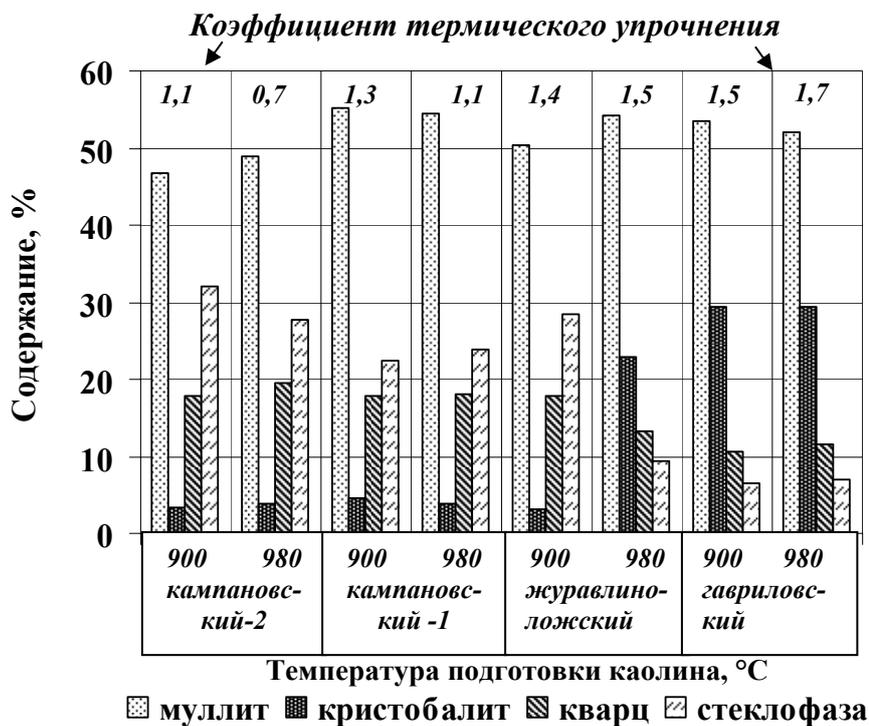
**Рисунок 2 – Влияние температуры предварительной подготовки каолина (900 и 980°С) на коэффициент термического упрочнения и фазовый состав изделий при температуре обжига 1450°С**
