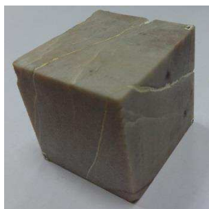
Рис. 2 Кубический керн для анализа анизотропии проницаемости по жидкости в пластовых условиях
