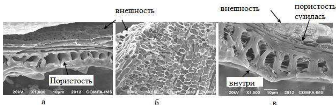
Рис. 3 Структура золы после сжигания при температуре 850 °C а - поверхность золы огрубела из-за перегрева; б- головка отделившегося диоксида кремния; в- пористость полученного угля сузилась
