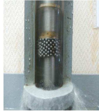
Рис. 6. Заклинивание шаров в затрубном пространстве
