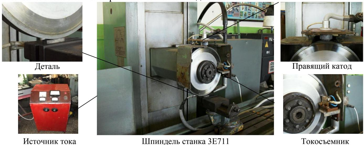
Рис.1. Станок 3E711, модернизированный для реализации комбинированного электроалмазного шлифования
