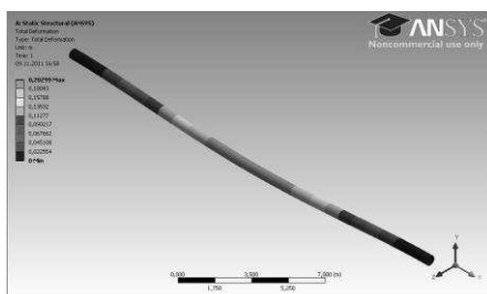
Рис. 5 Деформации, возникающие в газопроводе при осадке грунта
