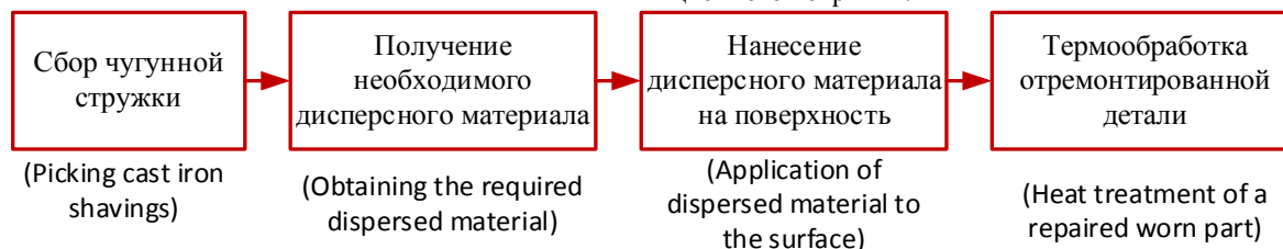
Рис. 5. Схема предложенной технологии получения антифрикционного композиционного покрытия
