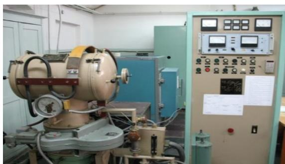
Рисунок 17 - Электрическая вакуумная печь сопротивления СНВЭ-1.3.1/16
