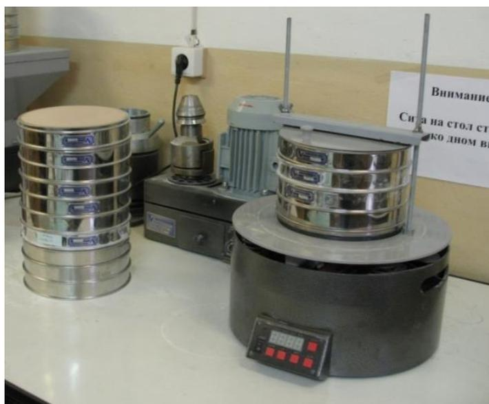
Рисунок 14 - Анализатор для ситового анализа вибрационный лабораторный
