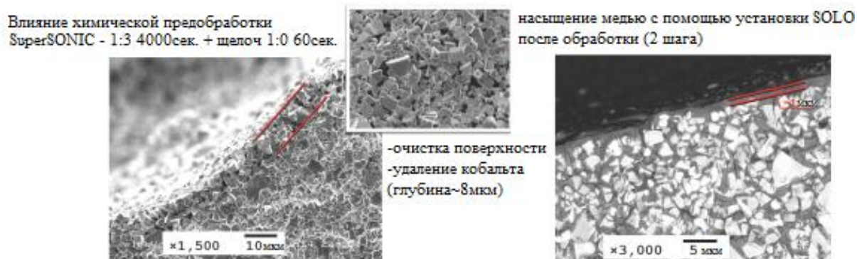
Рисунок 3.1. Микроструктура штампа фильтра после осаждения меди
