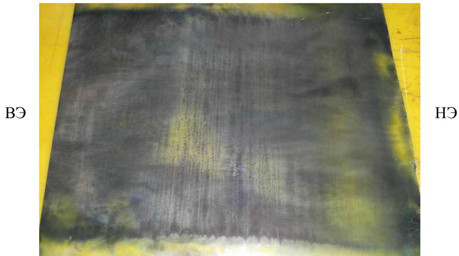
Рис. 5 – Следы страт при взрыве Cu фольги 16 мкм размером 250×180 мм, ВЭ – высоковольтный электрод, НЭ – низковольтный электрод
