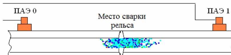
Рис.10. Линейная локализация сигналов АЭ при сварке рельсов
